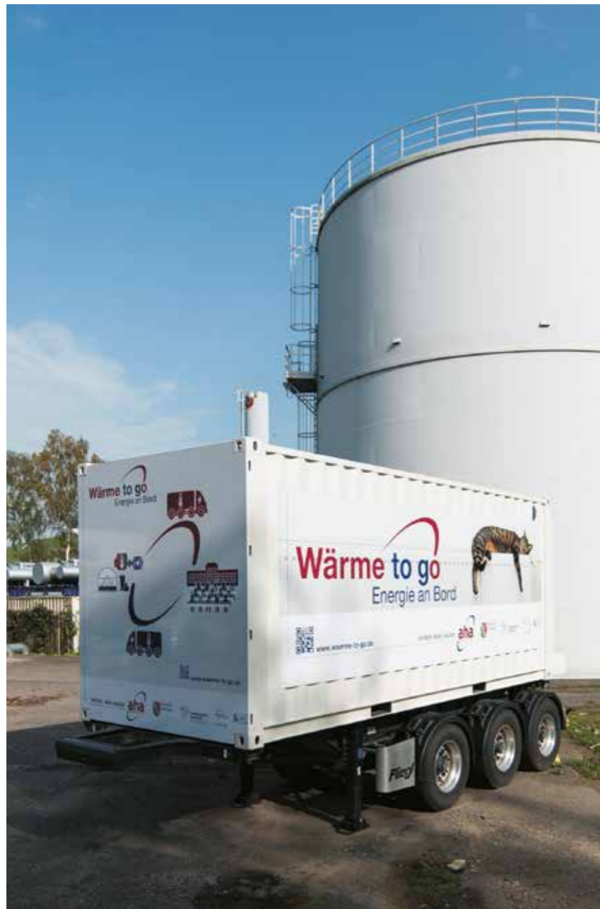
Im Container wird Wärme gespeichert, transportiert und ausgeliefert.
